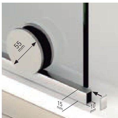
Rodamiento + Sección perfil inferior.
