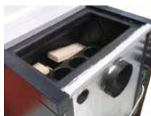
Acceso al intercambiador de calor
