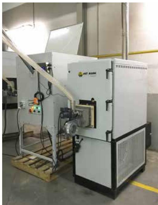
Ensayo de calefactor industrial BIO MANN con funcionamiento a pellet.
